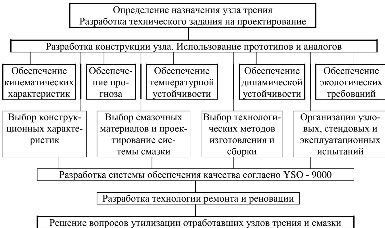
Р и с. 5.34. Общая схема основных элементов создания конструкции, узлов трения
