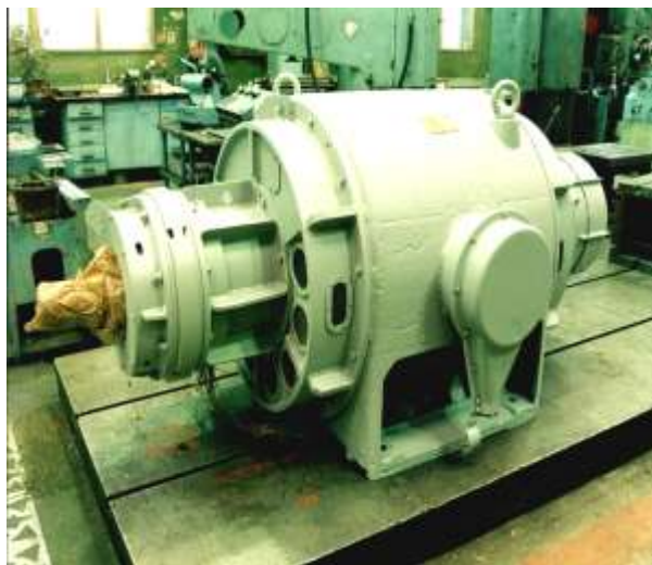
Рис.1. Электромагнитные подшипники, смонтированные на асинхронном электродвигателе N=620 кВт.
